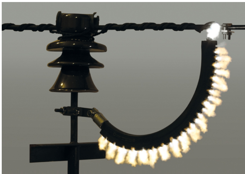
Рисунок 9 - Фотография разрядника при срабатывании
