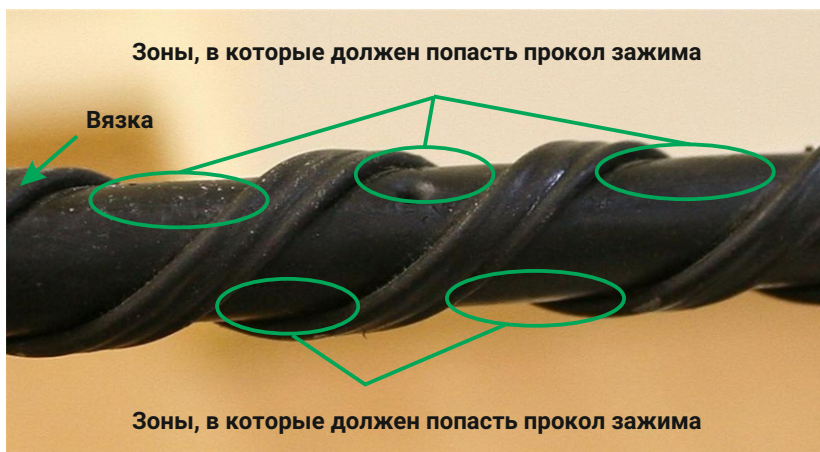
Рисунок 6 - Верное место расположения на проводе прокола зажима
